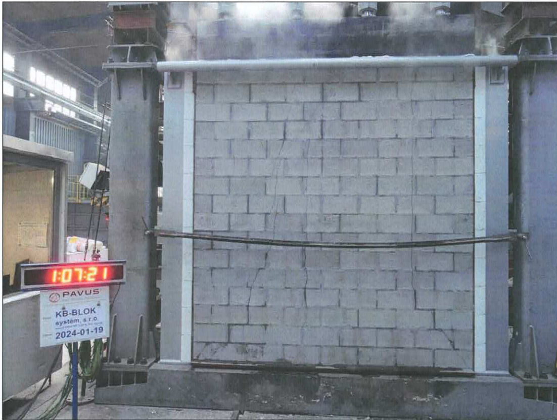
Průběh zkoušky – 68. minuta
